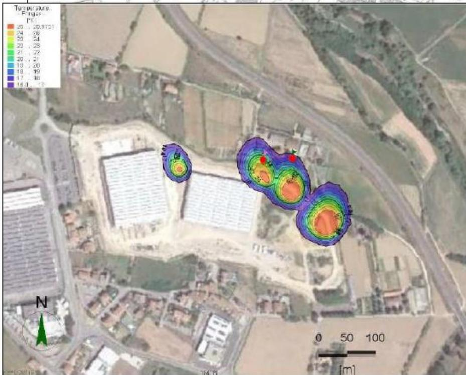
Studio tramite un modello di trasporto del calore degli effetti prodotti dalla reimmissione di acqua calda in falda per il raffrescamento estivo (scambio termico) e di acqua fresca in falda per il riscaldamento invernale (geotermia), indotta da un impianto a ciclo aperto "open loop" costituito da 8 pozzi (4 per l'emungimento e 4 per la reimmissione) a servizio dei fabbricati industriali interni all'area P.I.P. in località Levanella, di proprietà Prada S.p.A.
